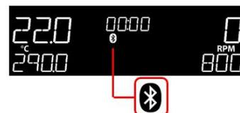
Caso o botão a esquerda (C) for pressionado para ligar o aquecedor, o ícone do Bluetooth piscará, indicando que não há conexão
