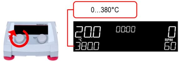
2. Pour allumer la plaque chauffante, appuyez sur le bouton gauche (C) et maintenez-le enfoncé jusqu'à ce que l'appareil émette un signal sonore et que le témoin de chauffage (N) s'allume.
