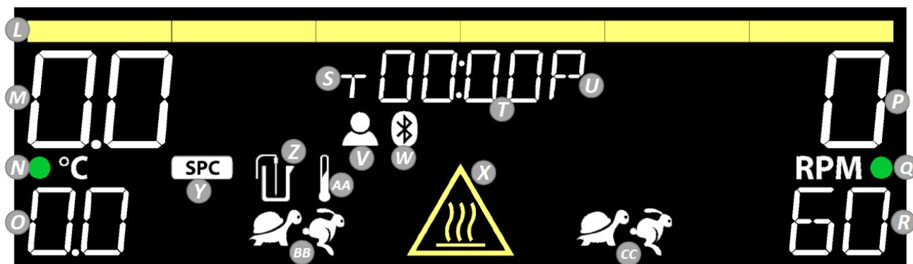
**L. Barra indicadora do aquecedor:** Acende-se quando o aquecedor está  $\geq 40^{\circ}\text{C}$ .
