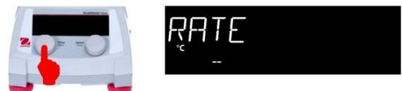
5. Per cambiare lo SmartRate™ del riscaldatore, premere brevemente la manopola sinistra (C).
