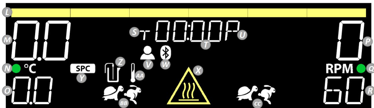
**L. Varmevarmerindikatorlinje:** Lyser, når varmestanden er  $\geq 40^{\circ}\text{C}$ .
