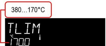
5. Pressione brevemente o botão a esquerda (C) para confirmar a configuração. A temperatura irá parar de piscar.
