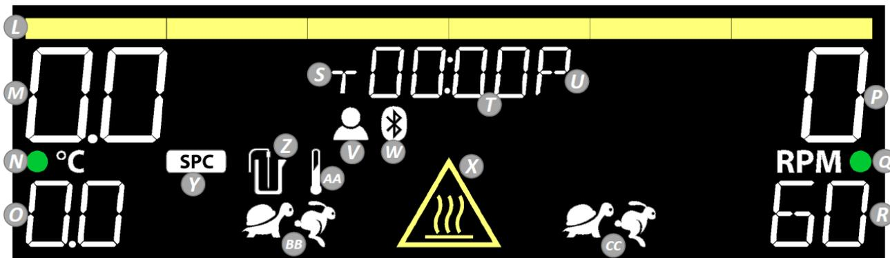
**L. Varmeindikator:** Lyser opp når temperaturen er  $\geq 40^{\circ}\text{C}$ .
