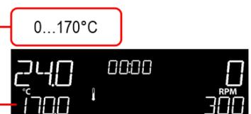
**Nota:** Enquanto está usando a sonda externa, SmartHeat™ ainda vai limitar a temperatura do aquecedor. Isso pode causar que a amostra aqueça a uma taxa mais lenta e a um pico a uma temperatura mais baixa de que a configuração SmartHeat™
