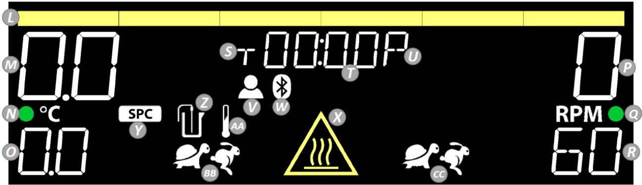
**L. A fűtés jelzőcsíkja:** Világít, ha a fűtőegység hőmérséklete  $\geq 40^{\circ}\text{C}$ .
