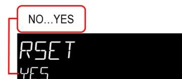
7. Pressione e segure o botão a esquerda (C) até que o dispositivo emita um bipe para confirmar a configuração de Redefinição.
