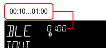
16. Pressione brevemente o botão a esquerdo para confirmar a configuração de minuto desejada e alterar a configuração de hora.
