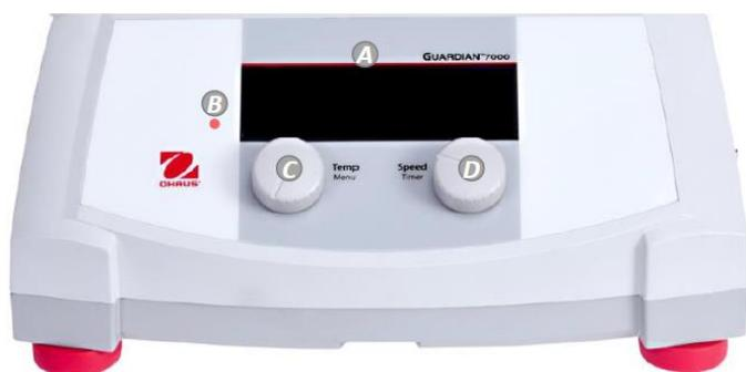
**A. Displej****B. Indikátor zapojení****C. Levý knoflík:** Ovládá teplotu a menu nastavení**D. Pravý knoflík:** Ovládá rychlost a nastavení času**E. USB Port****F. Externí port pro sondu RTD**
