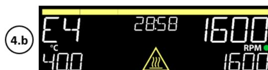
**Nota:** Para apagar um código de erro E4 ou E7, desligue e ligue novamente o interruptor de espera (J). O dispositivo estará pronto para uso normal.
