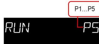
17. L'unità visualizzerà ogni passo del programma evidenziato se rimarrà inattivo per più di 2 secondi.
