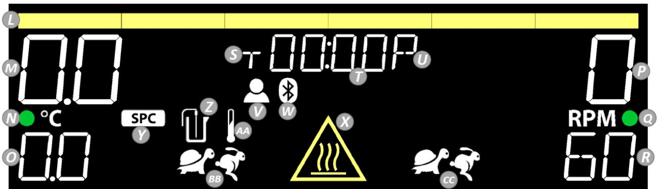
**L. Barre de température de l'élément chauffant:** s'allume lorsque l'élément chauffant est  $\geq 40$  °C.
