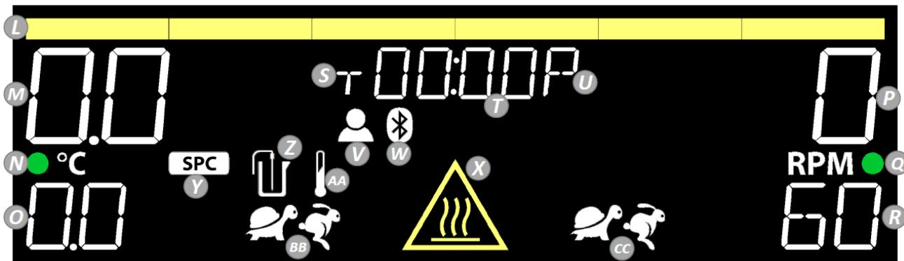
**L. Värme indikator:** Lyser när värmaren är  $\geq 40$  ° C.
