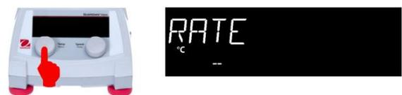
5. Para alterar a SmartRate™ do aquecedor, pressione brevemente o botão a esquerda (C). O ícone da configuração atual da SmartRate™ começará a piscar.
