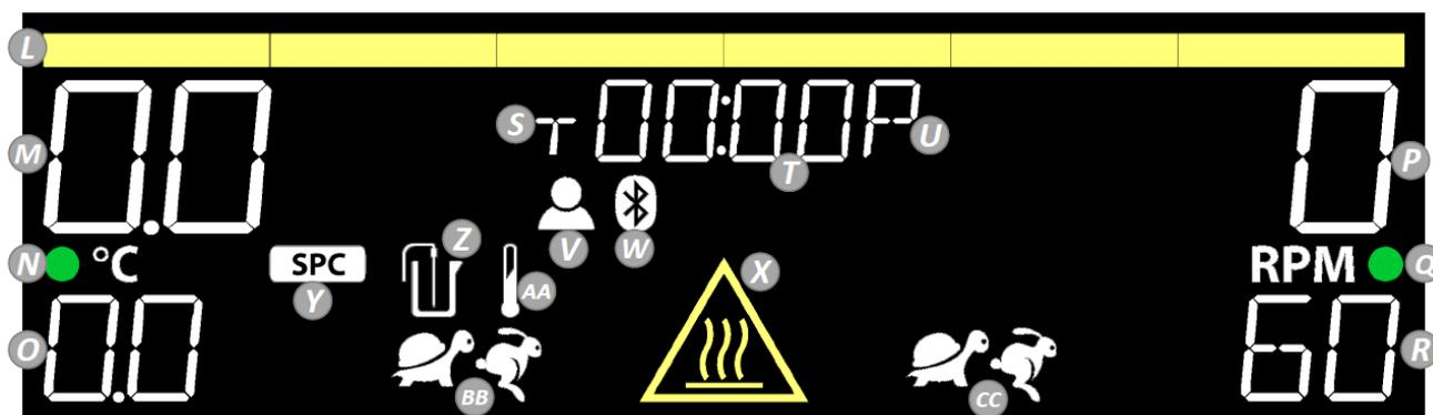
**L. Lišta indikátoru ohřevu:** Rozsvítí se, když je teplota ohřevu  $\geq 40^{\circ}\text{C}$ .
