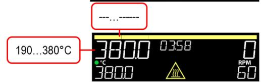
e) Lorsque la température de l'élément chauffant (M) est supérieure à 40 °C, le voyant de mise en garde de plaque chaude (X) et la barre de température de l'élément chauffant (L) s'allument.
