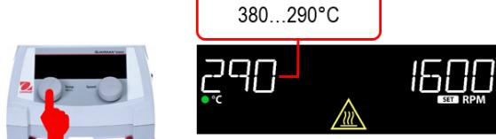
4. Para apagar el calentador, mantenga pulsada la ruleta izquierda (C) hasta que la unidad emita un pitido y desaparezca el indicador del calentador (M).
