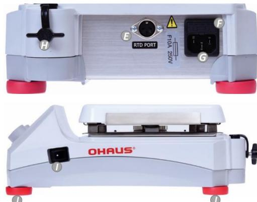
**A. Bildschirm anzeigen****B. Standby-Anzeige****C. Drehknopf:** Steuert die Temperatur und das Einstellungsmenü**E. Externer RTD-Sondenanschluss****F. Sicherung****G. Leistungseinspeisungsmodul (PEM)****H. Gewindeknopf für Zubehörstange****I. Standby-Schalter****J. Füße:** Nicht einstellbar
