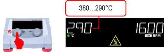
4. Para desligar o aquecedor, pressione e segure o botão a esquerdo (C) até o dispositivo emitir um bipe e o indicador do aquecedor (M) desaparecer.
