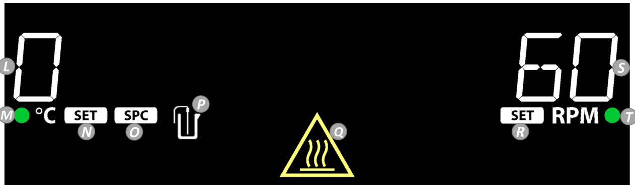
**L. Temperatura del calentador:** Cambia a la temperatura de la sonda externa cuando la sonda está enchufada y P está iluminado.
