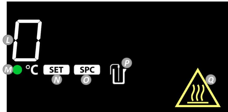
**L. Heizfunktionstemperatur:** Schaltet auf externe Sondentemperatur, wenn die Sonde eingesteckt ist und P leuchtet.
