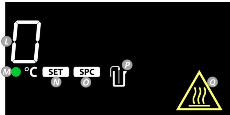
**L. Lämmittimen lämpötila:** Mittaa anturin ulkoisen lämpötilan, kun se on kytketty ja P on päällä.
