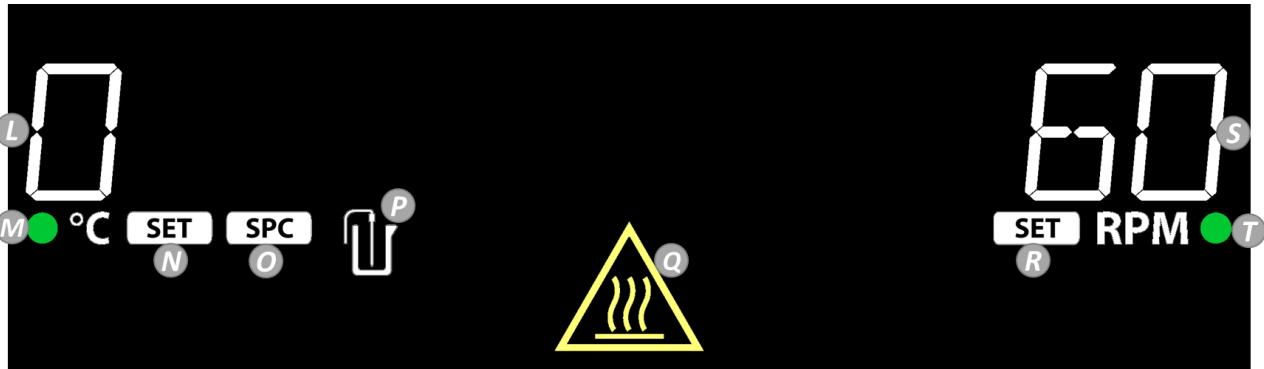
**L. Heizfunktionstemperatur:** Schaltet auf externe Sondentemperatur, wenn die Sonde eingesteckt ist und P leuchtet.
