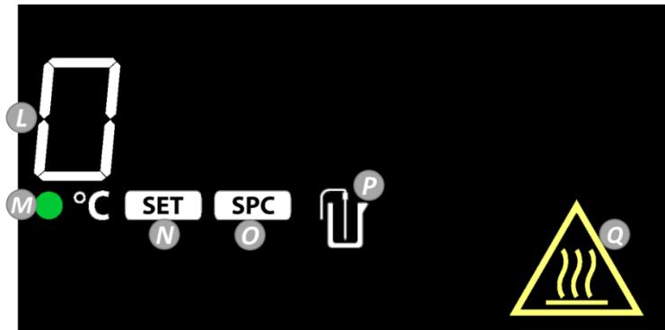
**L. Température de l'élément chauffant:** bascule sur la température de la sonde externe lorsque celle-ci est branchée et que P est allumé.
