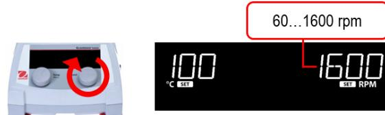
2. Para encender el agitador, mantenga pulsada la ruleta derecha (D) hasta que la unidad emita un pitido y se ilumine el indicador del agitador (T).
