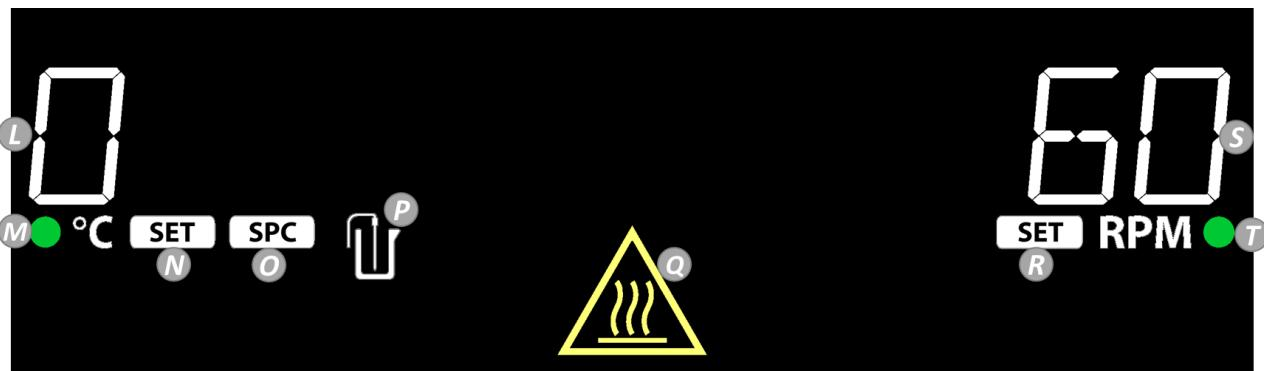
**L. Temperatura do aquecedor:** Alterna para a temperatura da sonda externa quando a sonda está conectada e P acende.
