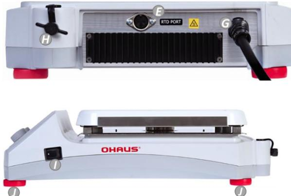
**A. Näyttöruutu****B. Valmiustilan ilmaisin****C. Vasen nuppi:** Sätelee lämpötilaa ja asetusvalikkoa**D. Oikea nuppi:** Ohjaa nopeutta**E. Ulkoinen RTD-koetinportti****G. Virtajohto****H. Lisävarren kierrepainike****I. Valmiustilan kytkin****J. Jalat:** Ei säädettävissä
