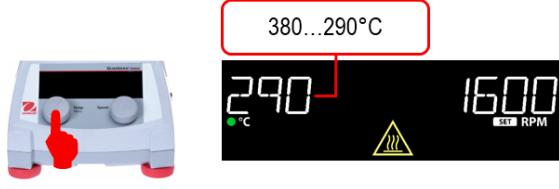
4. Pour éteindre la plaque chauffante, appuyez sur le bouton gauche (C) et maintenez-le enfoncé jusqu'à ce que l'appareil émette un signal sonore et que le témoin de chauffage (M) disparaisse.
