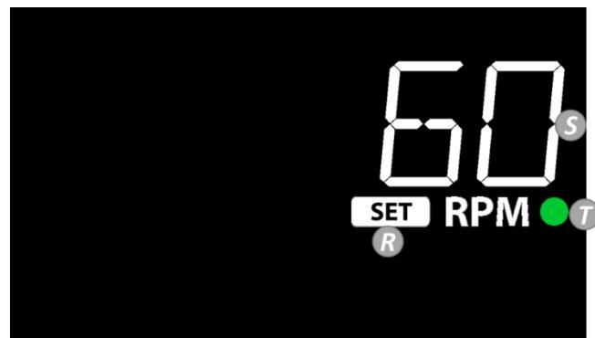
**R. Indicatore di impostazione della velocità:** si illumina fino a quando l'agitatore non raggiunge l'impostazione della velocità (S).
