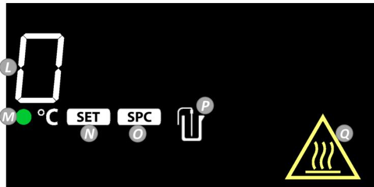
**L. A fűtőegység hőmérséklete:** Ha mérőegység van csatlakoztatva és a P világít, a külső mérőcsúcs hőmérsékletére vált.
