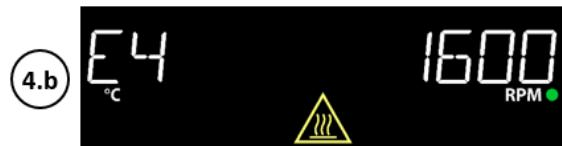
**Hinweis:** Um einen E4- oder E7-Fehlercode zu löschen, drücken Sie den Standby-Schalter (I) aus und wieder ein. Das Gerät ist dann für den normalen Gebrauch bereit.
