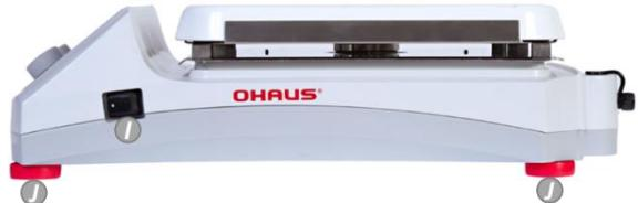
**A. Displayscherm****B. Stand-by Indicator****C. Linkerknop:** Regelt het temperatuur- en instellingenmenu**D. Rechterknop:** Regelt snelheid**E. Externe RTD Sondepoort****G. Netsnoer****H. Schroefdraadknop voor Accessoirestand****I. Stand-by Schakelaar****J. Voetjes:** Niet verstelbaar
