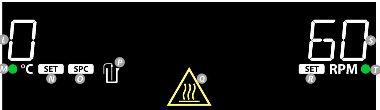
**L. Varmeelementets temperatur:** Endres til utvendig sondetemperatur når tilkoblet og P lyser.
