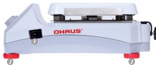
**A. Displayscherm****B. Stand-by Indicator****C. Knop:** Regelt het temperatuur- en instellingenmenu**E. Externe RTD Sondepoort****F. Zekering****G. Stroomingangsmodule (PEM)****H. Schroefdraadknop voor Accessoirestang****I. Stand-by Schakelaar****J. Voetjes:** Niet verstelbaar
