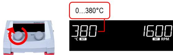
2. Para encender el calentador, mantenga pulsada la ruleta izquierda (C) hasta que la unidad emita un pitido y se ilumine el indicador del calentador (M).
