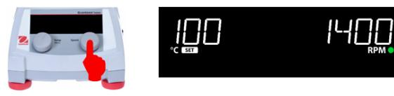
**Nota:** Si el ajuste de velocidad (S) permanece inactivo sin confirmación durante 4 segundos, se restablecerá la configuración actual.
