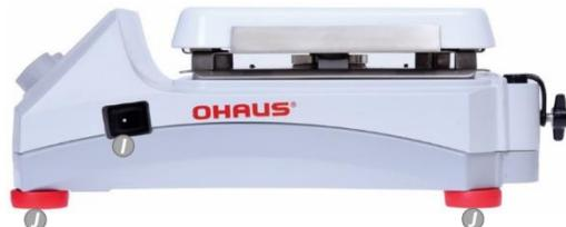
**G. Modul vstupu napájení (PEM)****H. Knoflík pro přidatnou tyčku****I. Přepínač to režimu spánku****J. Nožky:** Nejsou nastavitelné
