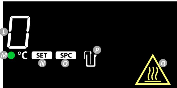
**L. VarmevarmerTemperatur:** Skifter til ekstern sondetemperatur, når sonden er tilsluttet, og P lyser.
