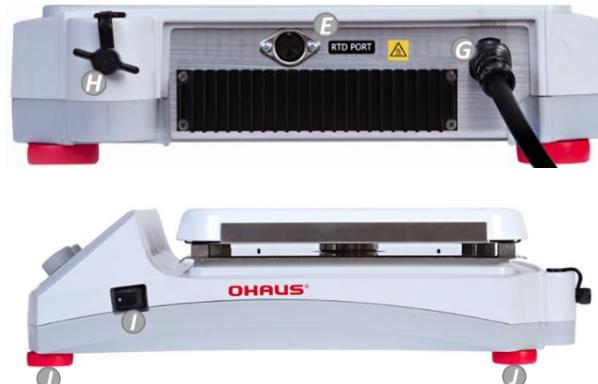
**A. Écran d'affichage****B. Indicateur de veille****C. Bouton de gauche:** réglage de la température et menu Paramètres**D. Bouton droit:** réglage de la vitesse**E. Prise de sonde RTD externe****G. Cordon d'alimentation****H. Bouton fileté pour la tige d'accessoire****I. Commutateur de veille****J. Pieds:** non réglables
