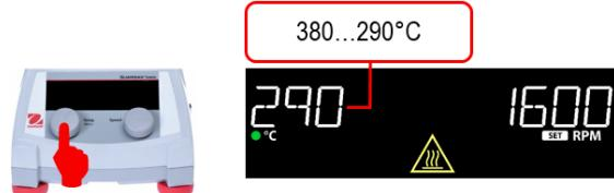
4. Per spegnere il riscaldatore, tenere premuta la manopola sinistra (C) fino a quando l'unità emette un segnale acustico e l'indicatore del riscaldatore (M) scompare.
