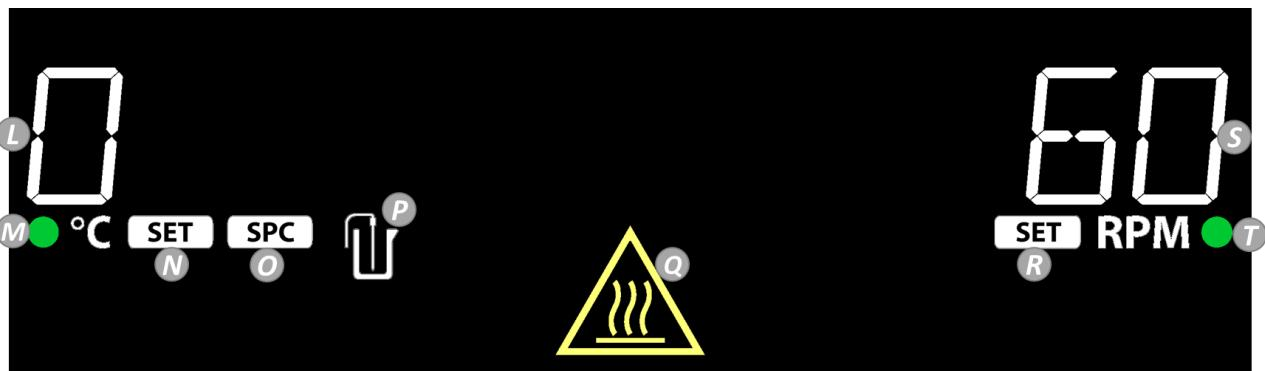
**L. Temperatura del riscaldatore:** passa alla temperatura della sonda esterna quando la sonda è inserita e la P è illuminata.
