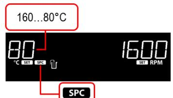
29. Halten Sie den linken Knopf (C) gedrückt, bis das Gerät einen Piepton abgibt und die Heizfunktionsanzeige (M) aufleuchtet.
