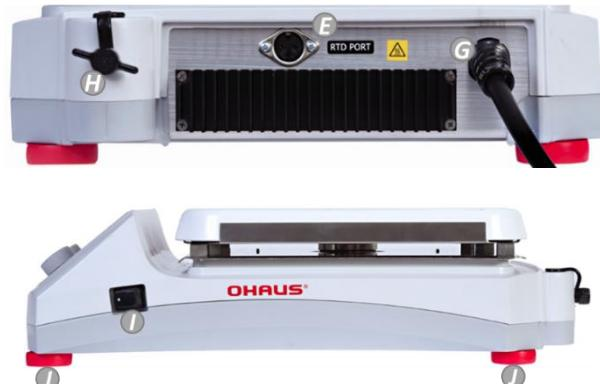
**A. Bildschirm anzeigen****B. Standby-Anzeige****C. Linker Drehknopf:** Steuert die Temperatur und das Einstellungsmenü**D. Rechter Knopf:** Steuert Geschwindigkeit**E. Externer RTD-Sondenanschluss****G. Netzkabel****H. Gewindekopf für Zubehörstange****I. Standby-Schalter****J. Füße:** Nicht einstellbar
