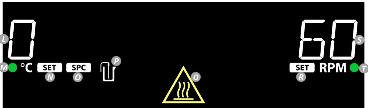
**L. Lämmittimen lämpötila:** Mittaa anturin ulkisen lämpötilan, kun se on kytketty ja P on päällä.
